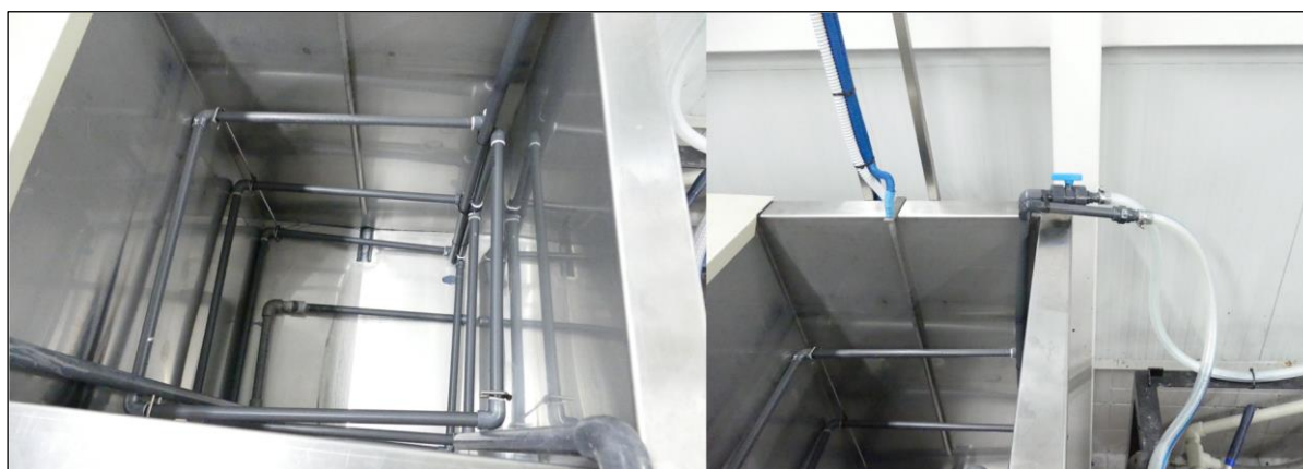
Figura 21 - Sistema de agitação por circulação do banho concebido para a tina A-24.
