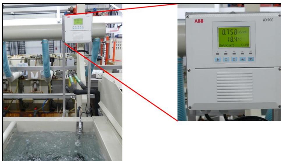
Figura 13 - Condutivimetro instalado na tina de lavagem A-37, que antecede a etapa de colmatagem. Neste caso, foi realizada uma alteração da qualidade da água nas tinas de lavagem A-36 e A-37, assim como nas tinas de colmatagem, A-35 e A-38, através da introdução de uma coluna de resina de leito misto, que é atravessada pela água desmineralizada que abastece estas quatro tinas. Esta coluna vai purificar a água desmineralizada, através de uma filtração iônica seletiva, removendo os sais dissolvidos e silicatos, resultando deste processo uma água de elevada pureza. Dado o custo da água
