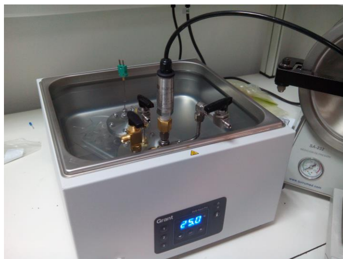
Figura 7 - Unidade experimental montada e utilizada para a determinação das curvas de carga, isotérmicas de equilíbrio de adsorção e picnometria de hélio.
