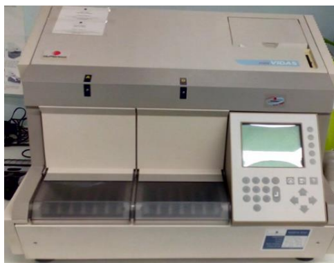
Figura 34. Equipamento Mini VIDAS® utilizado na determinação dos biomarcadores cardíacos.
