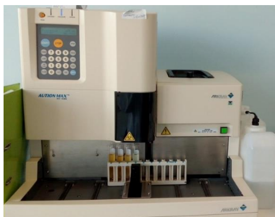
Figura 49. Analisador de bancada totalmente automatizado utilizado na análise sumária das urinas.
