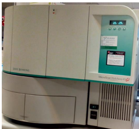
Figura 45. Equipamento MicroScan WalkAway 40SI utilizado na identificação bacteriana e respetivos testes de suscetibilidade aos antibióticos.
