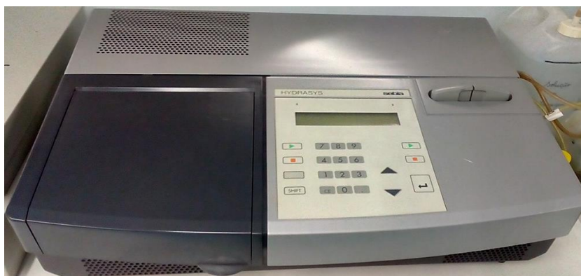
Figura 32. Equipamento HYDRASYS ® utilizado na realização da eletroforese de proteínas séricas.
