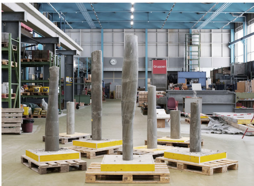
Figura 97 Alguns resultados da produção final, Smart Dynamic Casting, ETH Zürich, 2012-2015
