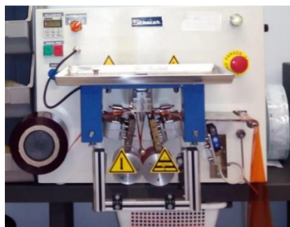
Figura 8 Máquina automática de reembalamento de comprimidos
