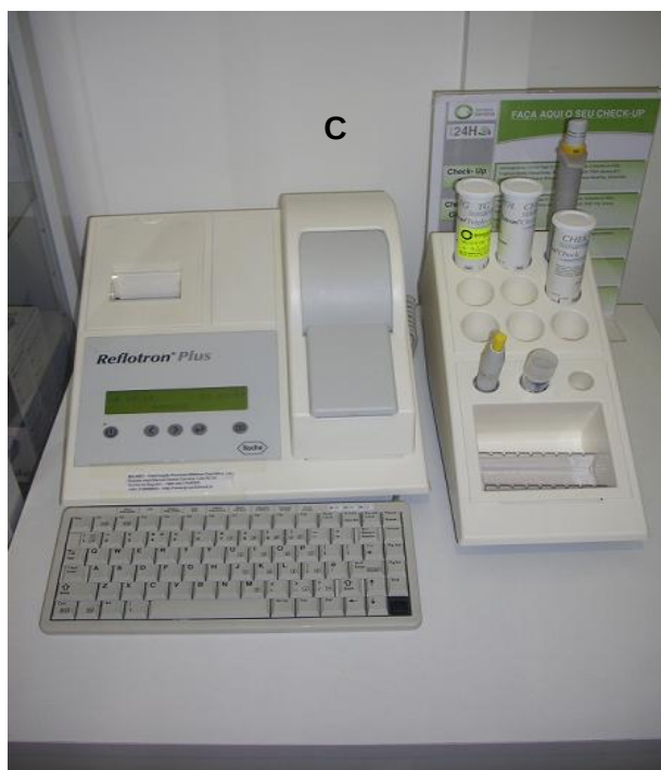
C. Reflotron Plus, Roche®. Equipamento que permite a medição do colesterol total e triglicerídeos
