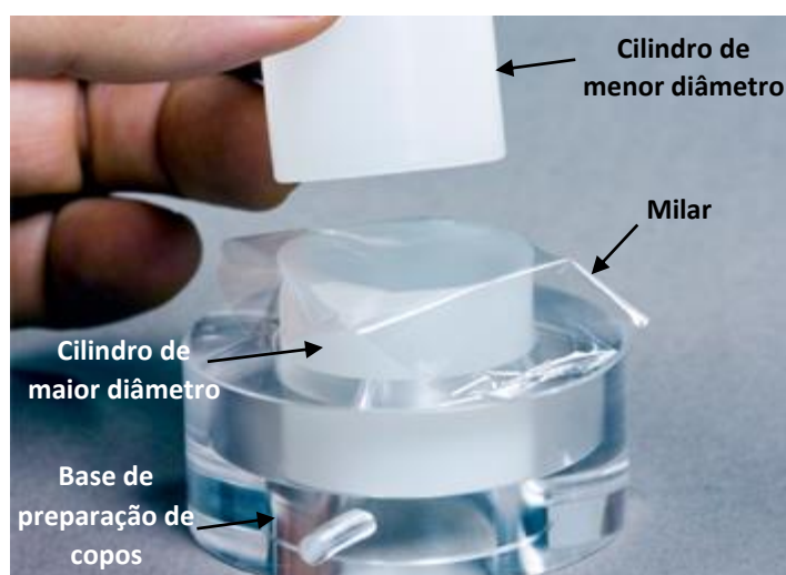
Figura 22 – Preparação de um copo amostral para o espectrómetro de XRF.(adaptado de [41])
