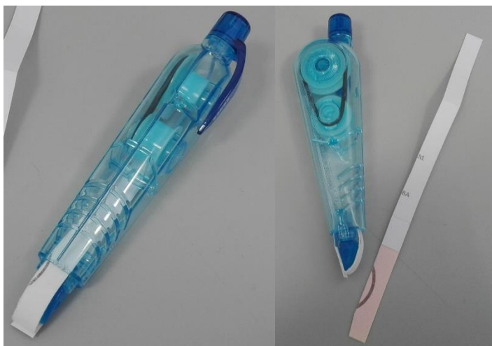
Figura 12. Objeto utilizado para transferir o material biológico dos diversos suportes para a tira de limpeza.
