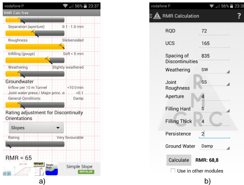
Fig. 21 – Cálculo do RMR básico através da aplicação: a) RMR Calc Free ; b) RMR & GRC
