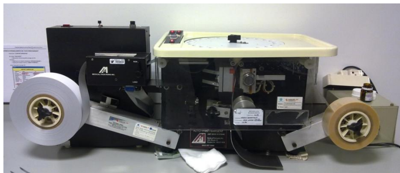
Figura 4 – Máquina semiautomática de reembalamento de comprimidos.
