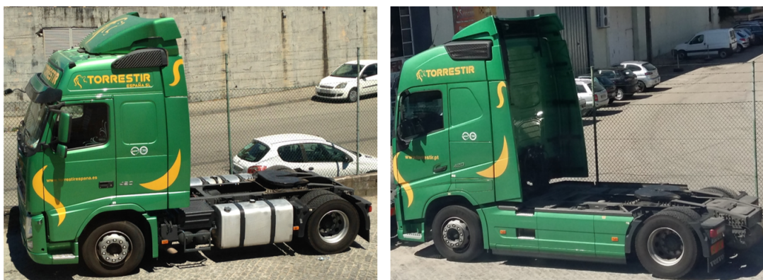
Figura 4.11: Dispositivos aerodinâmicos nos veículos da TORRESTIR. À esquerda: trator sem saias laterais; à direita: trator com saias laterais
