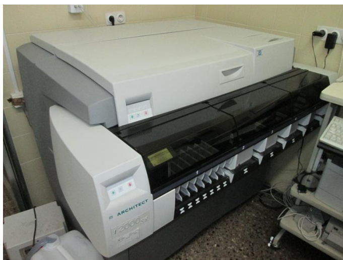
Figura 5 - Fotografia do equipamento de quantificação de fármacos: Architect® i2000 SR
