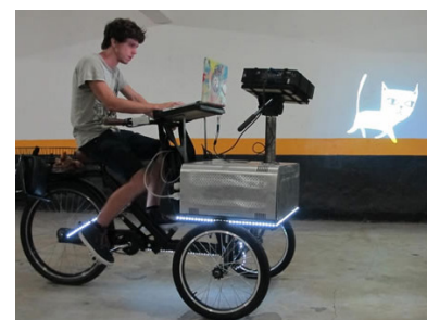
Fig. 53 - Veículo de transporte de projetores desenvolvido pela dupla VJ Suave
