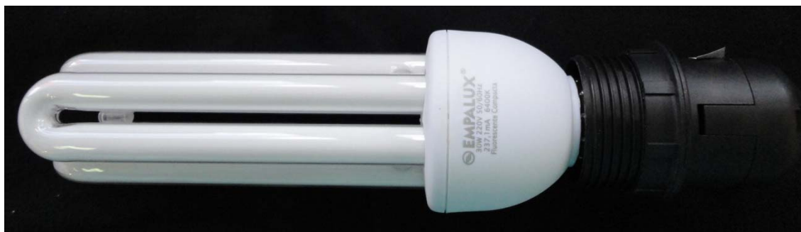
Figura 3 - Luz do candeeiro EMPALUX® (luz fluorescente compacta produzida na China, Lote: BSO 01, Modelo: F2 23016, F_p > 0,5 , t_a = -5 a 40^\circ\text{C} , t_c = 80^\circ\text{C} , com 30W, 220V, 50/60Hz, 237,1 mA e 6400^\circ\text{K} ).
