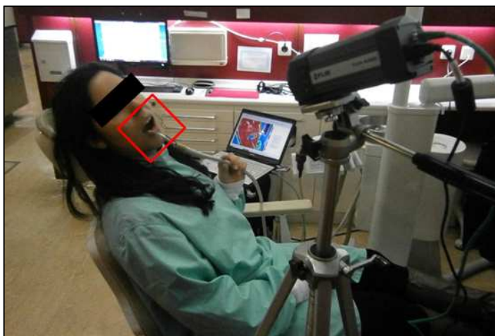
Figura 8 - Exemplo do procedimento aquando da mediação das temperaturas bucais. A câmara foi mantida à distancia de 0,9 metros. A zona limitada pelo retângulo vermelho indica a zona a ser avaliada posteriormente (Figura 9).
