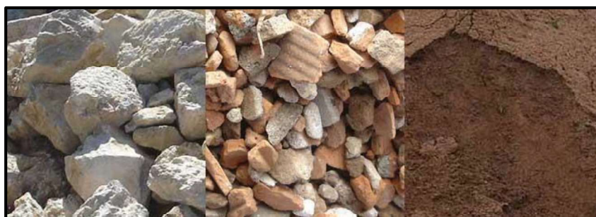
Fig.3.15- Resíduos de construção e demolição de diferentes granulometrias e constituição (adaptado do site www.rcd.pt )
