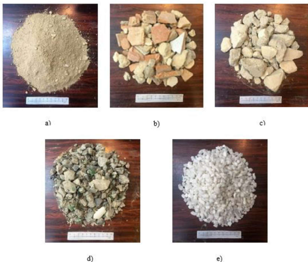
Fig.4.4- Materiais utilizados na danificação mecânica: a) RCD fino, b) RCD cerâmico, c) RCD de betão, d) cinzas, e) corundum
