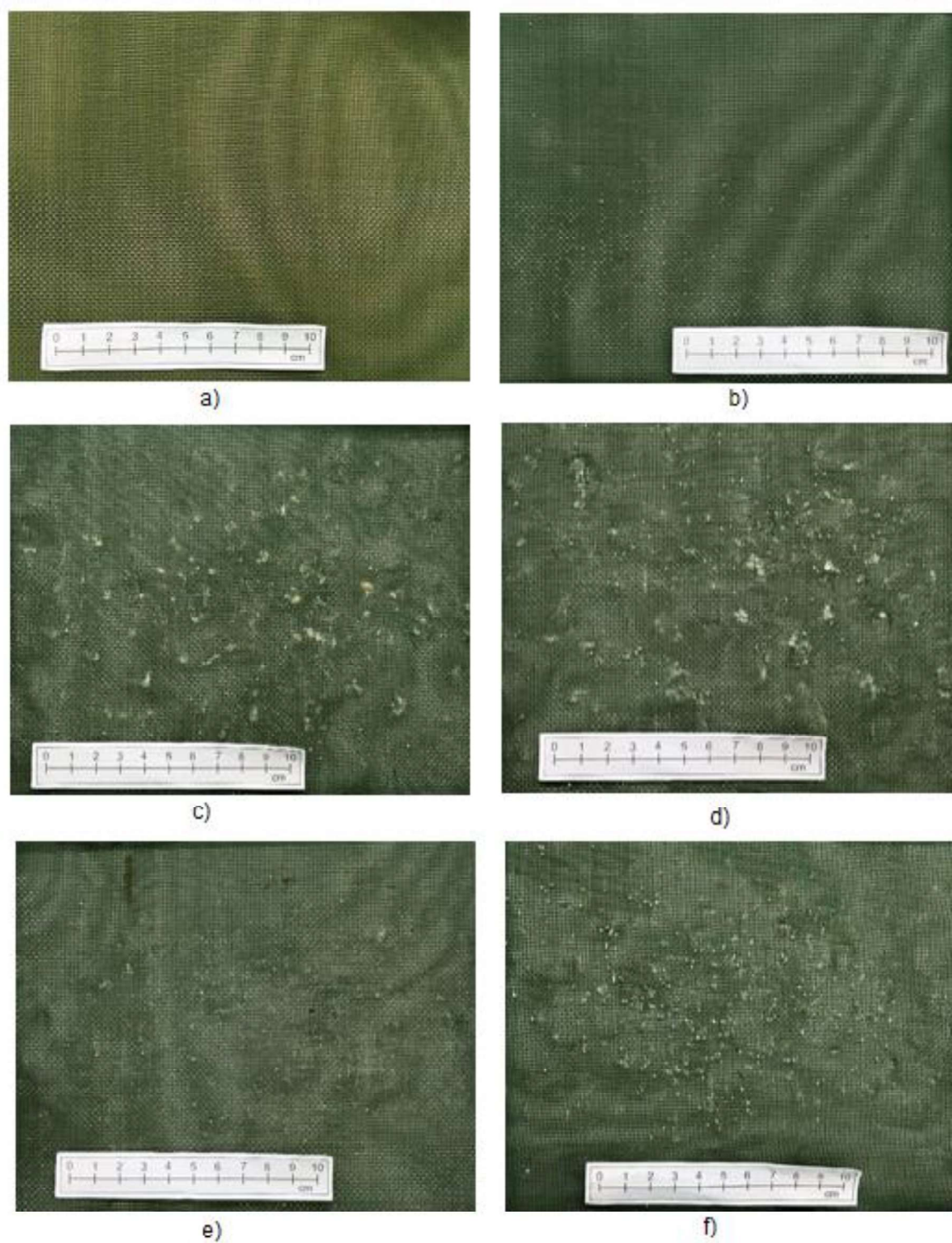
Fig.5.4- Geotêxtil T200: a) intacto; b) danificado com RCD fino; c) danificado com RCD cerâmico; d) danificado com RCD de betão; e) danificado com cinzas; f) danificado com corundum
