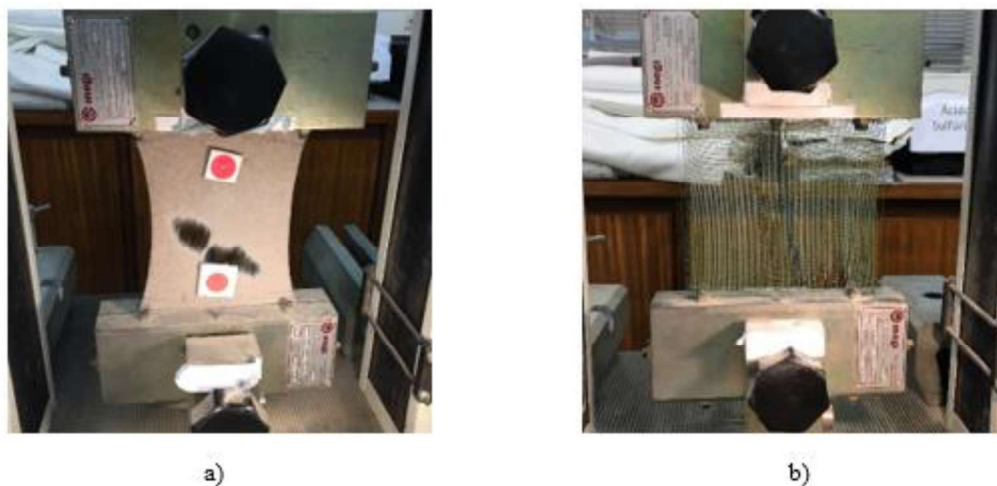
Fig.4.8- Ensaio de tração: a) geotêxtil NT110, com recurso a vídeo-extensómetro; b) geotêxtil T200, sem vídeo-extensómetro
