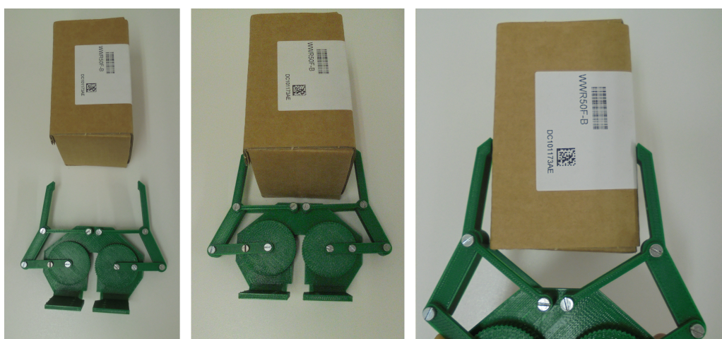
Figura 4.2: Manipulação de caixas: aproximação na posição abertura máxima, ajuste ao tamanho da caixa e por fim preensão da caixa.
