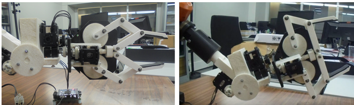
Figura 6.2: Testes efetuados aos mecanismos responsáveis pelos movimentos segundo as direções de rotação de ROLL e de PITCH .
