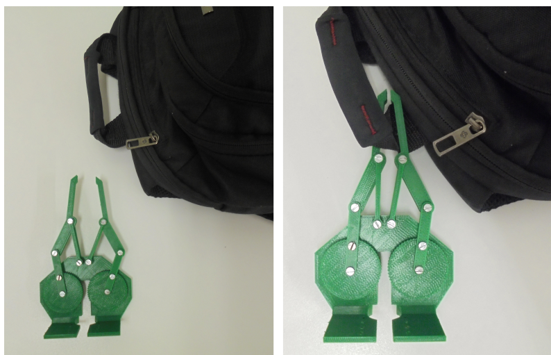
Figura 4.4: Manipulação de uma mochila: aproximação na posição abertura intermédia e por fim pega fechada.
