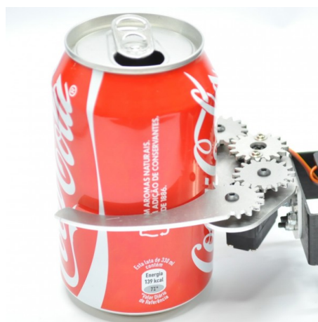
Figura 3.25: "Garra Bot'n Roll c/ servo" a manipular um objeto cilíndrico (lata) [15].
