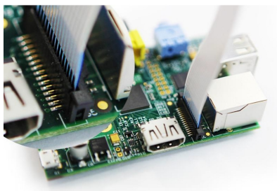
Figura 5.7: Ligação da câmara Raspberry Pi NoIR Camera v1.3 ao RPi[18].
