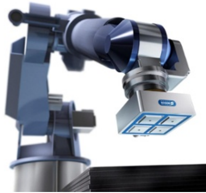
Figura 3.13: Gripper magnético ROBOTIQ recorrendo a eletroímãs [7].
