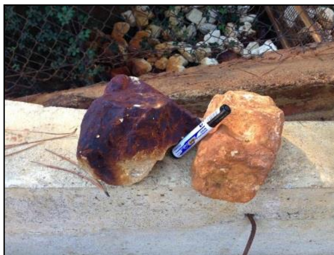
Figura 20. Pedras de calcário das escadas de arejamento
