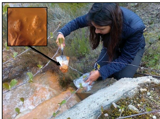
Figura 39. Precipitados da wetland 2, Amostra Jales Nº7
