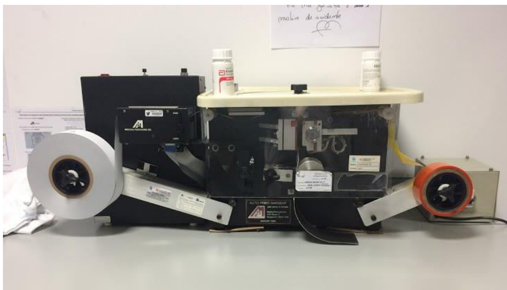
Figura 12: Máquina semiautomática para reembalamento de comprimidos.
