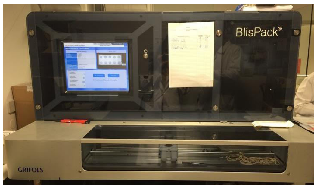
Figura 13: Máquina automática para reembalamento de comprimidos ainda em blisters.
