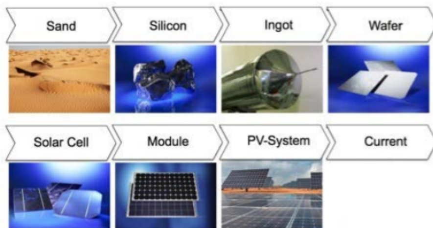
Figura 2.30: Desenvolvimento de um sistema fotovoltaico genérico. [49]
