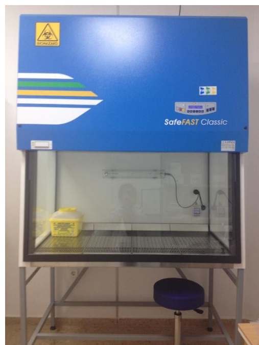
Figura 11 – Câmara de fluxo laminar SafeFast Classic®.
