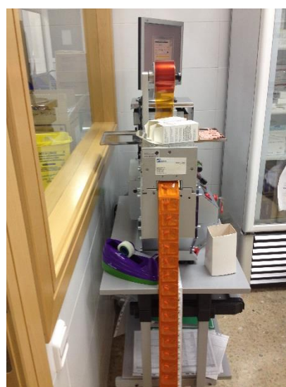
Figura 13, 14 e 15 – Processo de reembalagem e etiquetagem de unidades com recurso à máquina disponível no HILE.
