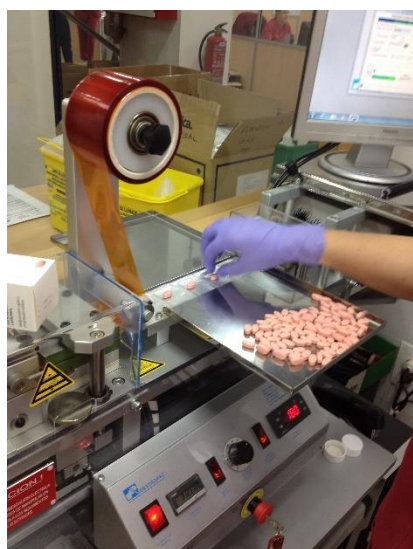
Figura 13, 14 e 15 – Processo de reembalagem e etiquetagem de unidades com recurso à máquina disponível no HILE.
