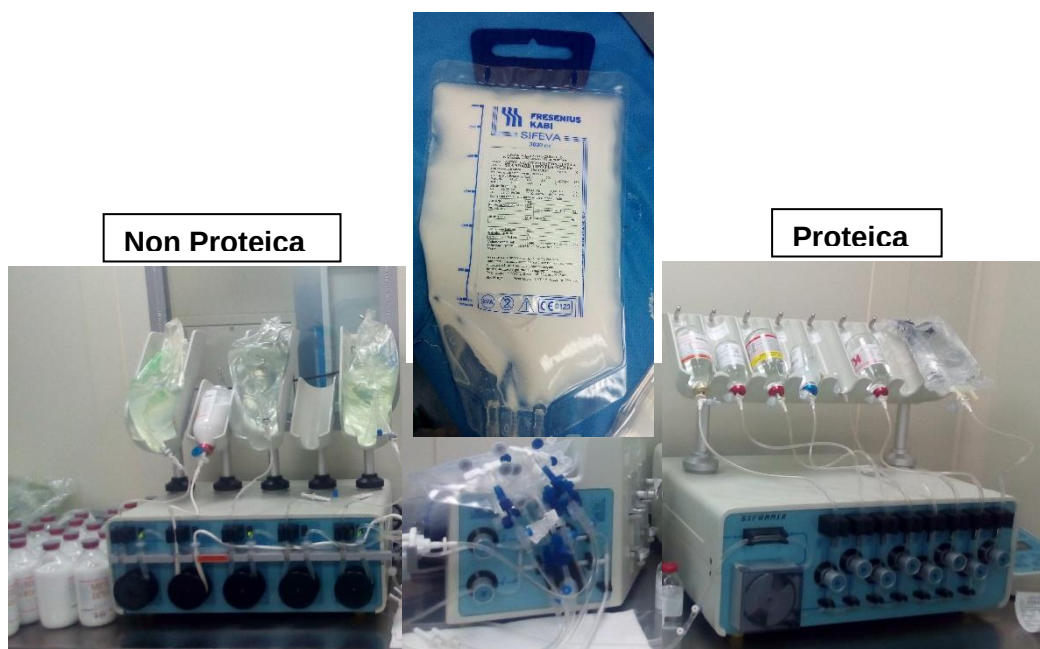
Figura 9 - Procedimento di riempimento automatizzato.
