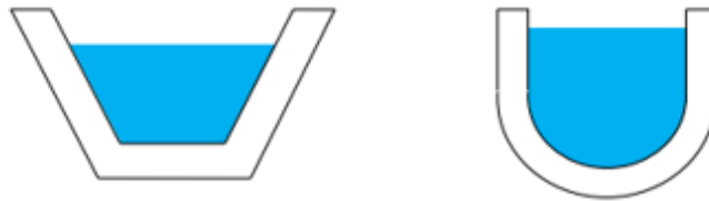
Figura 3.12: Área da secção transversal ou área molhada. [24]
