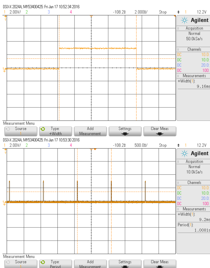
Figura 5.10: Tempo de execução adotando 3 nós no circuito equivalente do modelo térmico.
