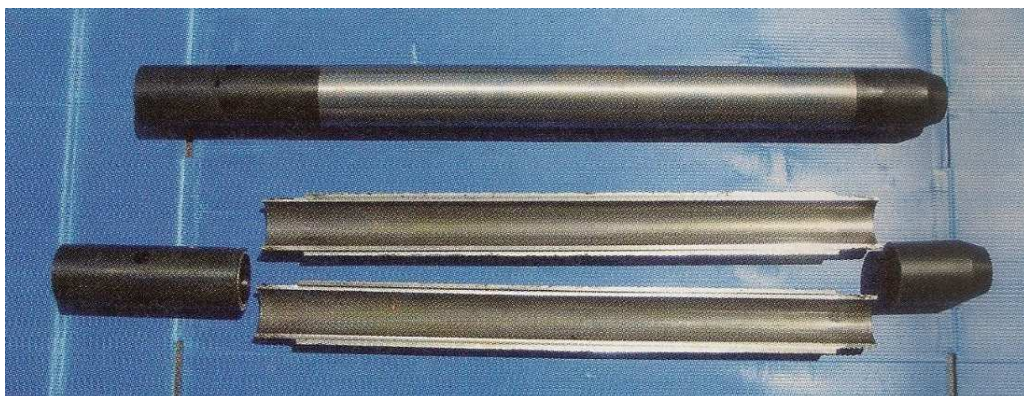
Figura 4 - Amostrador normalizado de Terzaghi (Matos Fernandes, 2011)
