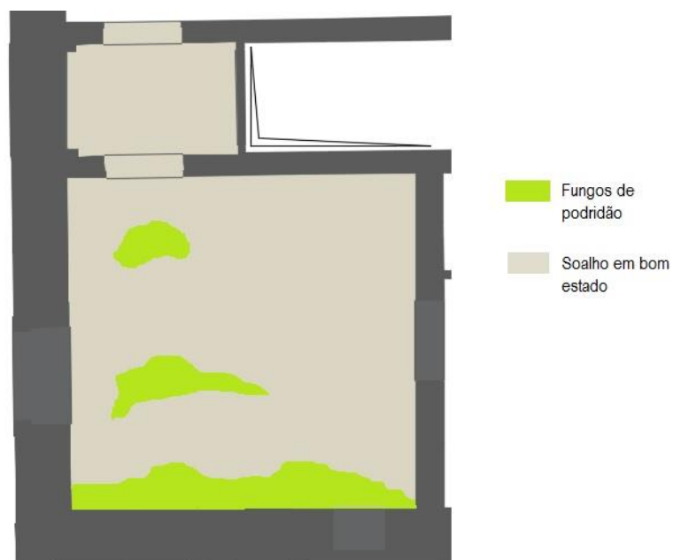
Fig. 4.22 – Área da superfície inferior do soalho afetada por fungos de podridão
