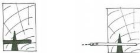
Fig. 5.5 – Reparação de fendas com cola epoxídica e varões de reforço (Lopes, 2009)
