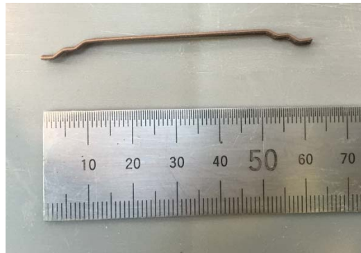
Fig.27 – Fibras utilizadas no betão
