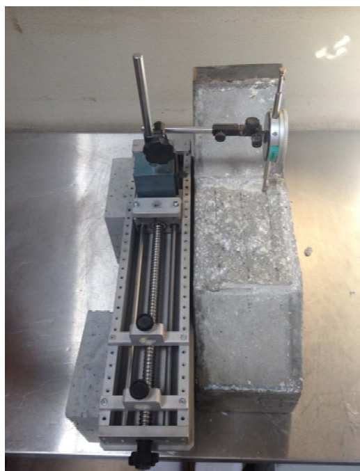
Fig.50 – Esquema de medição da rugosidade da superfície de corte
