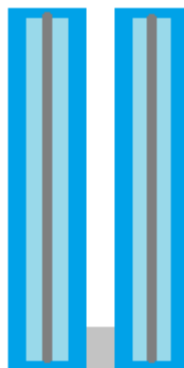
Fig.29 – Vidro Duplo constituído por dois Vidros Laminados (LL)
