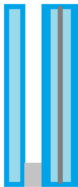
Fig.26 – Vidro Duplo constituído por um Vidro Monolítico e um outro Vidro Laminado (ML)
