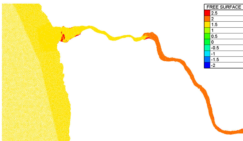
Figura 5.108- Elevação da superfície livre no estuário na preia-mar para um caudal de 1000 \text{ m}^3\text{s}^{-1} .
