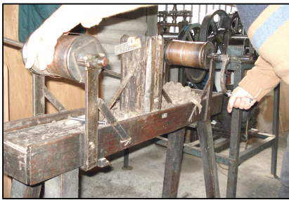
Carrinho de puxar o fio – instrumento de madeira rectangular composto por dois rolos dispostos nas extremidades e uma manivela. Aparelho usado para esticar o fio de metal, com o auxílio de uma tenaz, no qual o fio é puxado e enrolado trespessando o fio pela fieira e pelos rubis.
