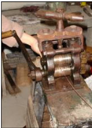
Cilindro – aparelho com dois rolos lisos, em aço, usado para estender as barras de chapa e apresenta sulcos de dimensões variadas para produzir fio. O sistema de funcionamento pode ser manual – mecanismo munido por uma manivela – ou eléctrico. Este processo é comumente conhecido por estirar ou laminar . Ver laminador .
