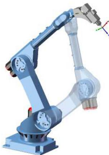
Figura 16 - Exemplo de duas configurações possíveis para o robô para a mesma posição/orientação da ferramenta.
