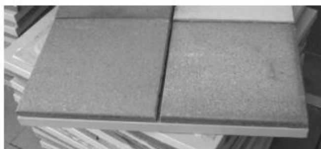
Figura 3.3. – Placas cerâmicas constituídas por parafina macro encapsulada (Cerón, Neila e Khayet, 2011)
