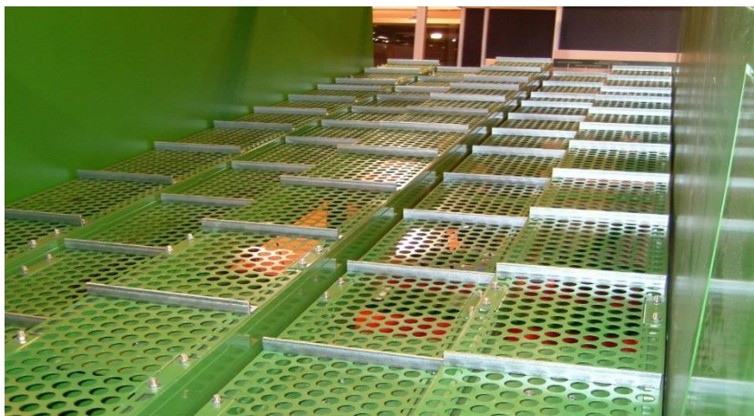
Figura 8 - Interior de um separador balístico
