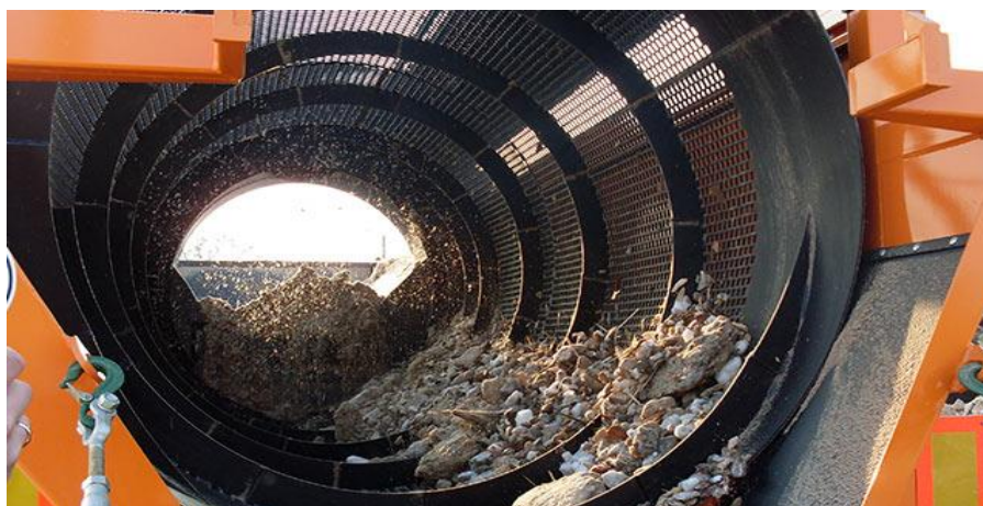
Figura 7 - Interior de um trommel
