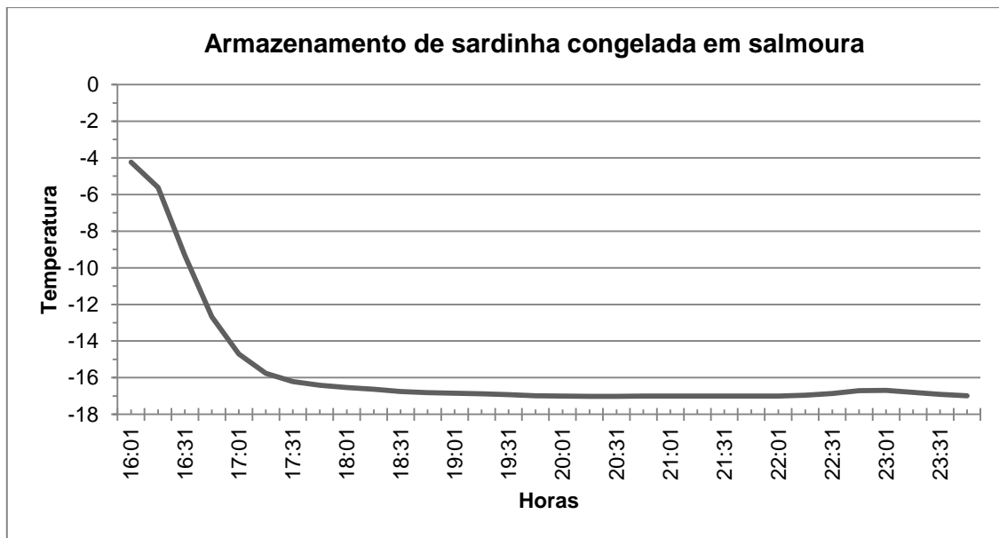
Gráfico 48 - Variação da temperatura no centro de um peixe, que foi congelado em salmoura, durante o seu armazenamento.
