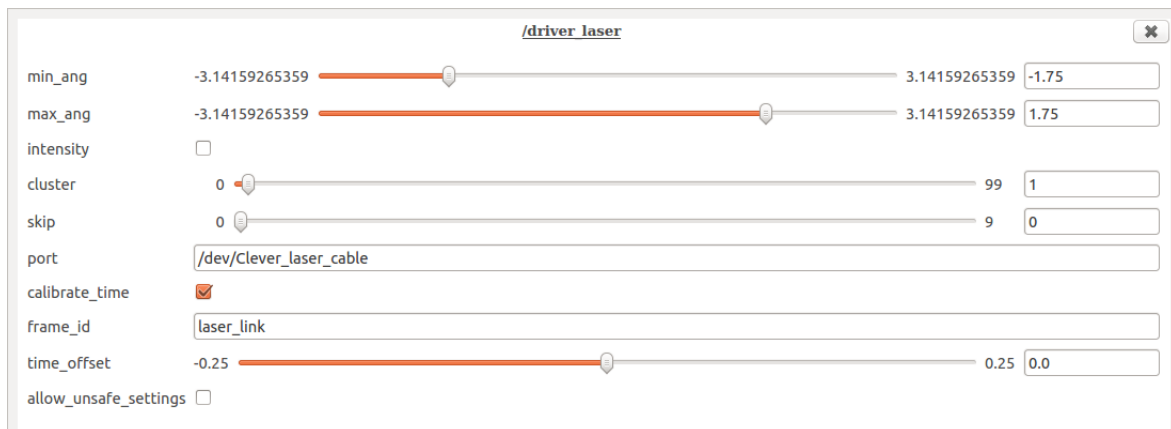
Figura 3.25: Parâmetros ajustáveis em runtime , com o dynamic_reconfigure do driver do laser.
