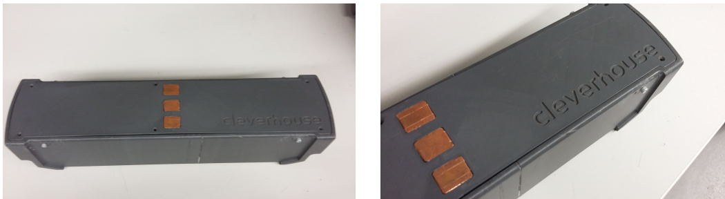
Figura 3.2: Caixa que possui internamente as baterias para a alimentação elétrica do robô.
