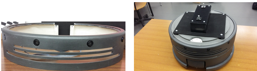
Figura 3.15: (a) Sonares SRF01 integrados na placa pertencente à zona média do robô. (b) Robô com a placa dos sonares montada.
