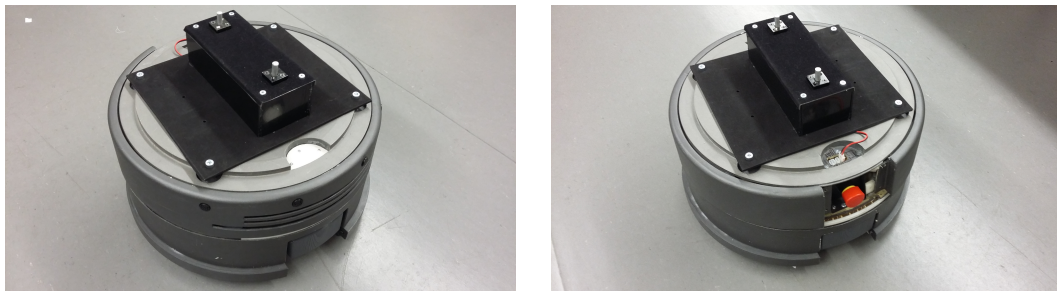
Figura 3.18: Estrutura integrada na superfície superior do robô para o sistema de transporte de prateleiras móveis.
