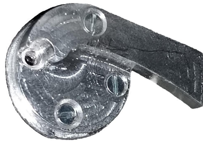
Figura 4.3: Peça de alumínio acoplada aos servomotores, para o levantamento automático da caixa de baterias.
