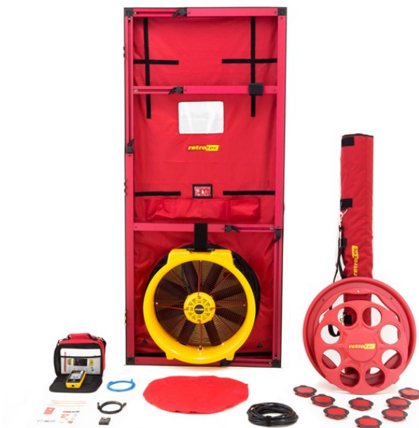
Fig. 12 – Constituintes da Porta Ventiladora (Retrotec, 2016).
