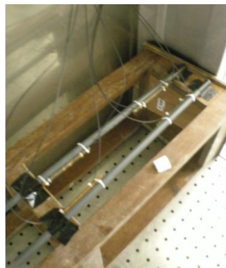
Figura 4.50: Colocação dos sensores dentro da câmara climática.
