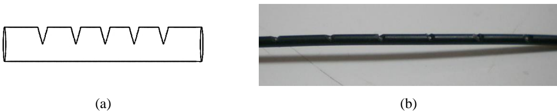
Figura 4.25: Sensor POF: a) Esquema do sensor; b) Visualização dos sulcos na fibra.
