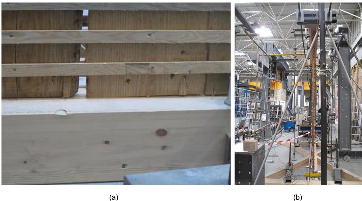
Figura 4.46 – Parede de tabique simples durante o ensaio: a) detalhe da extremidade inferior das tábuas; b) vista transversal da deformação da parede
