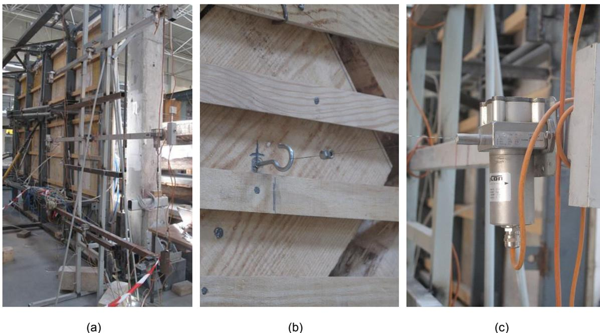
Figura 3.14 – Sistema que permite medir os deslocamentos do pano de parede para fora do seu plano: a) pórtico fixo e respetivos LVDTs b) ligação do fio do LVDT à parede; c) LVDT de fio
