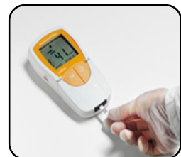
Esquema 1: Procedimento de medição de colesterol e triglicerídeos com o aparelho Accutrend Plus Copas [7].
