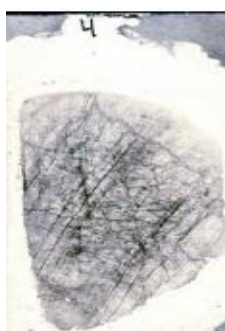
Figura 12 - Lâmina delgada de uma amostra de fluorite. Guerrero (2014)
