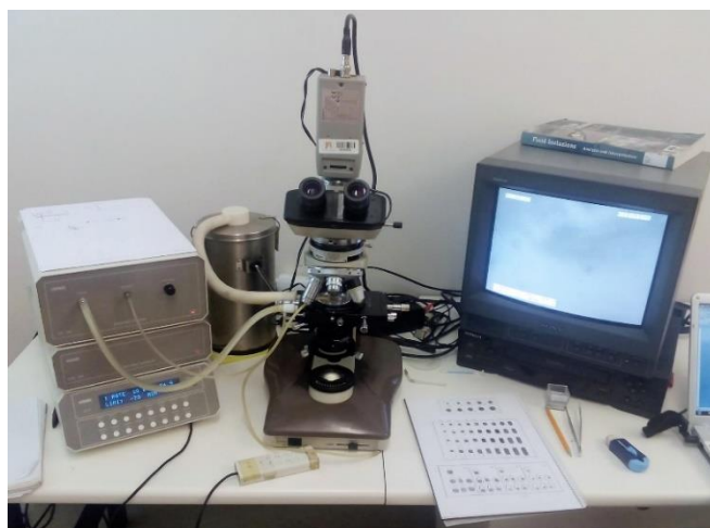
Figura 19 - Microscópio petrográfico Nikon Labophot-2 Pol de luz transmitida equipado com platina Linkham THSM-600.
