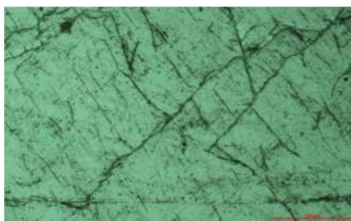
Figura 13 – Fotografia ao microscópio de luz transmitida de uma secção fluorite massiva de tamanho centimétrico (2x). Guerrero (2014)
