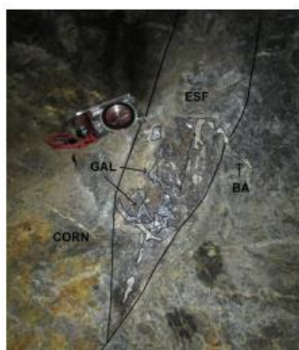
Figura 8 - Filão decimétrico de galena (GA), esfalerite (ESF), barite (BA) e corneana (CORN). Guerrero (2014).
