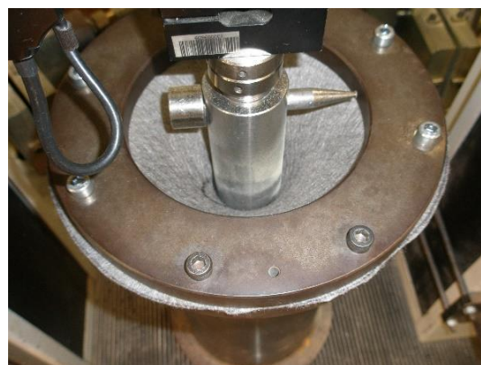
Fig. 3.22 – Pilão avançado durante o ensaio de punção estático
