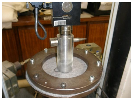
Fig. 3.21 – Início do ensaio com o pilão encostado no provete
