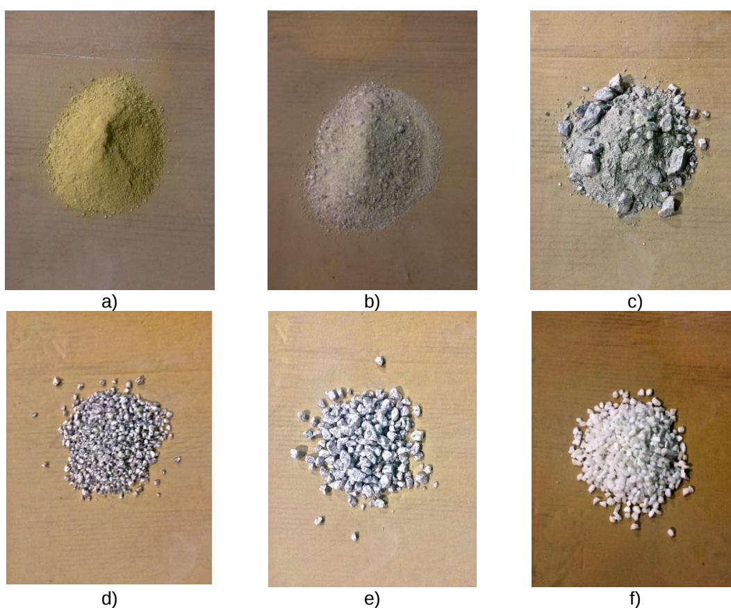
Fig. 3.11 – Solos usados no ensaio de danificação mecânica: a) areia siltosa; b) areia 0/4; c) tout-venant ; d) brita 4/8; e) brita 6/14; f) corundum
