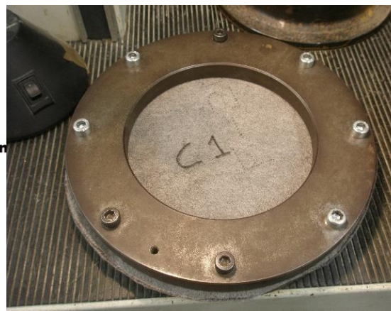
Fig. 3.19 - Montagem do provete entre os anéis de aço
