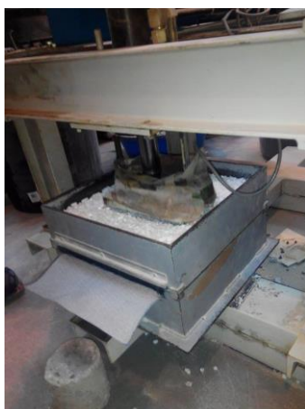
Fig. 3.10 - Equipamento no início do ensaio de danificação mecânica
