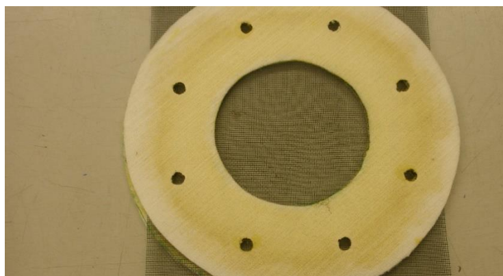
Fig. 3.20 –Provede de um geotêxtil tecido preparado para ser ensaiado
