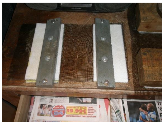
Fig. 3.16 – Colagem dos provetes dos geotêxteis tecidos
