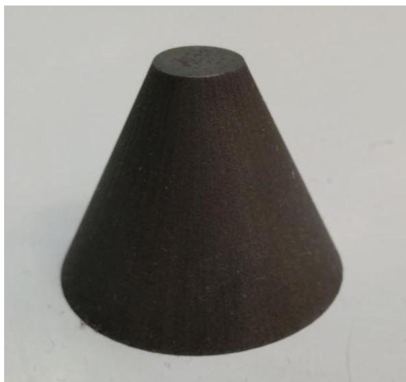
Figura 47 – Cone após erosão com fio de molibdénio
