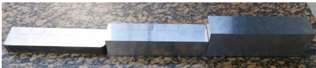
Figura 15 – Placas de aço AISI 1045 usadas nos ensaios
