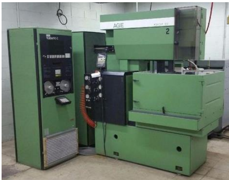
Figura 8 – Máquina de electroerosão por fio do fabricante AGIE, do final dos anos 70. Fonte: [15], consultado em 2016-01-14
