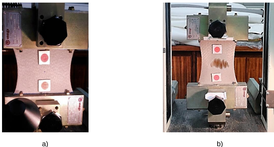
Fig. 4.9 – Ensaio de tração: a) provete montado com alvos durante o ensaio; b) provete após ocorrer a rotura.
