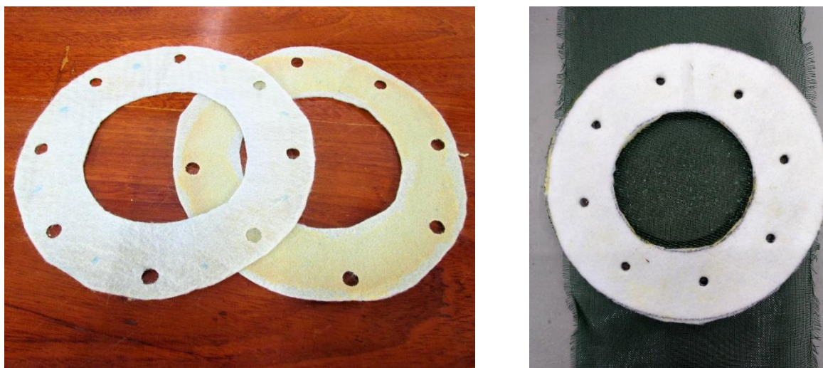
Fig. 4.11 – Proвете GT200 usado no ensaio de punção estático: a) moldes utilizados; b) método de Sandwich .
