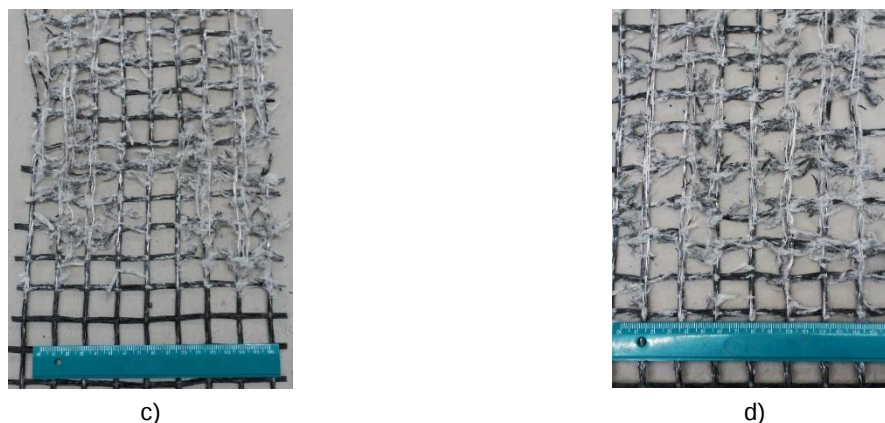
Fig. 5.12 – Geogrelha GG300: a) Intacto; b) Após DM; c) Após abrasão; d) Após DM + Abrasão.
