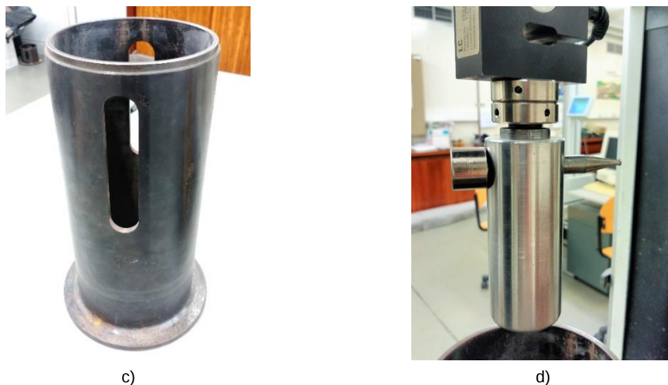
Fig. 4.10 – Equipamento utilizado no ensaio de punção estático: a) vista geral; b) sistema de aperto (dois anéis); c) suporte vertical; d) pilão.
