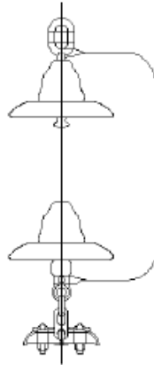
Figure 6 - Hastes de descarga utilizadas em isoladores em suspensão
