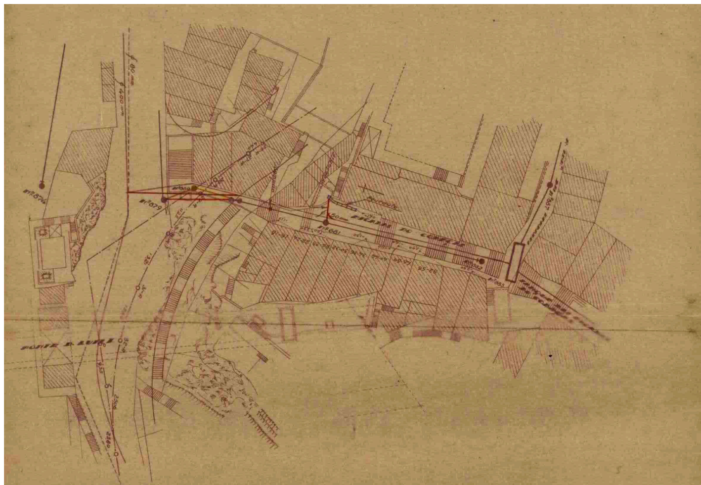
Figura 6 – Projeto de alteração do coletor geral de saneamento na estrada marginal (A.D.P.)
