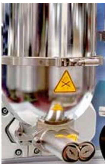
Figura 2.1 Doseador de fusos gémeos (K-Tron)
