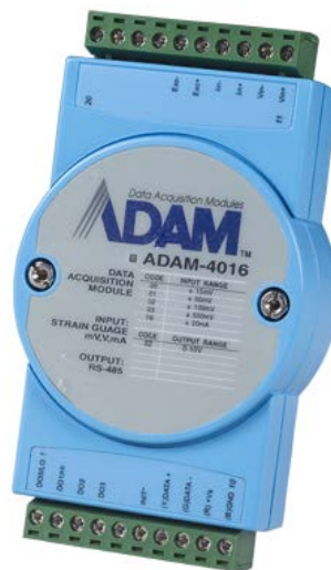
Figura 3.23 Aquisição e amplificação de sinal ADAM-4016-A2E
