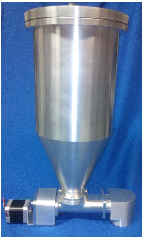
Figura 3.35 Montagem do Doseador vista lateral
