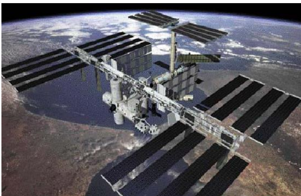
Figura 3.20 - Painéis fotovoltaicos de silício monocristalino na Estação Espacial Internacional [23]
