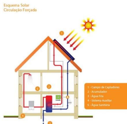
Figura 2.3 - Princípio de funcionamento de painéis solares térmicos [4]
