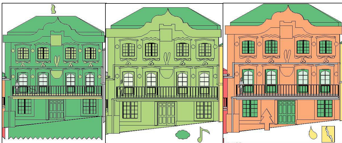
Fig. 86 – Alçado do nº de caso 3: Grupo “Segurança” (Esquerda), Grupo “Saúde” (Centro), Grupo “Degradação” (Direita)
