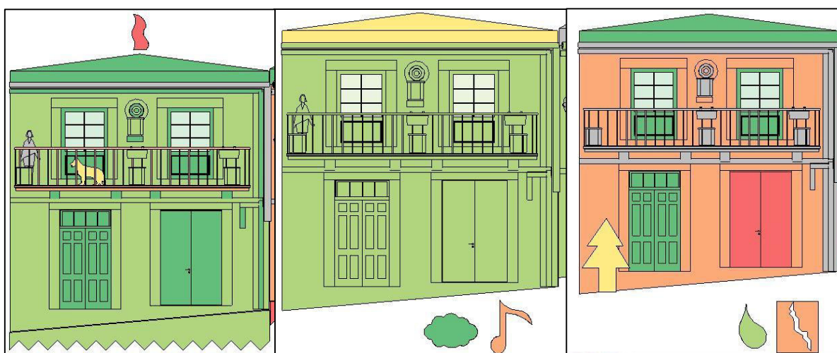
Fig. 82 – Alçado do nº de caso 1: Grupo “Segurança” (Esquerda), Grupo “Saúde” (Centro), Grupo “Degradação” (Direita).
