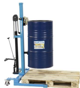
Ilustração 43 – Equipamento proposto para a movimentação de bidões
