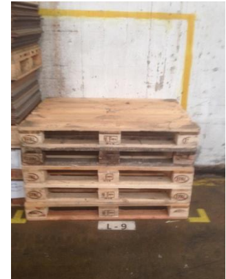
Ilustração 28 – Marcações de piso e altura para euro paletes
