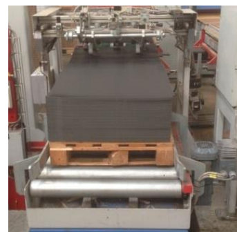
Ilustração 14 – Alimentador e Mesa Elevatória do Bottom Layer
