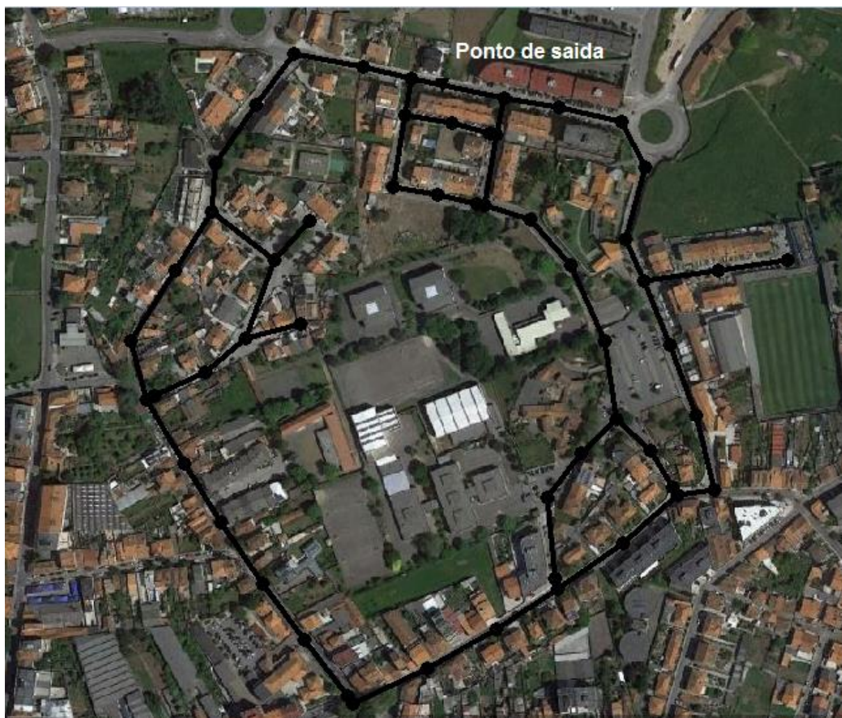
Fig.7.2 – Rede com caixas de visita e coletores
