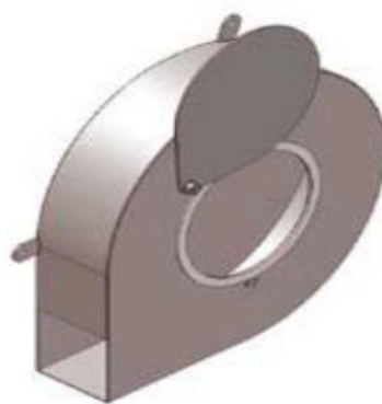
Fig.6.24 – Porta de bypass do dispositivo de controlo de caudal [25]
