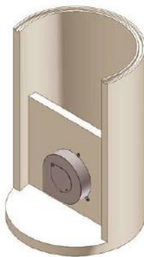
Fig.6.27 – Câmara Hydro-Brake com pequeno reservatório [25]
