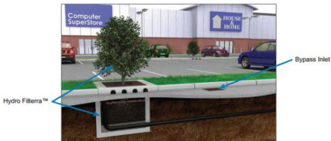
Fig.6.30 – Hydro BioCell e dispositivo de entrada secundário [26]
