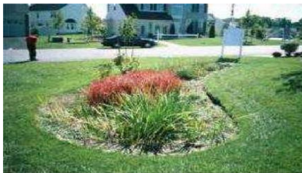
Fig.5.2 – Zona permeável para permitir infiltração
