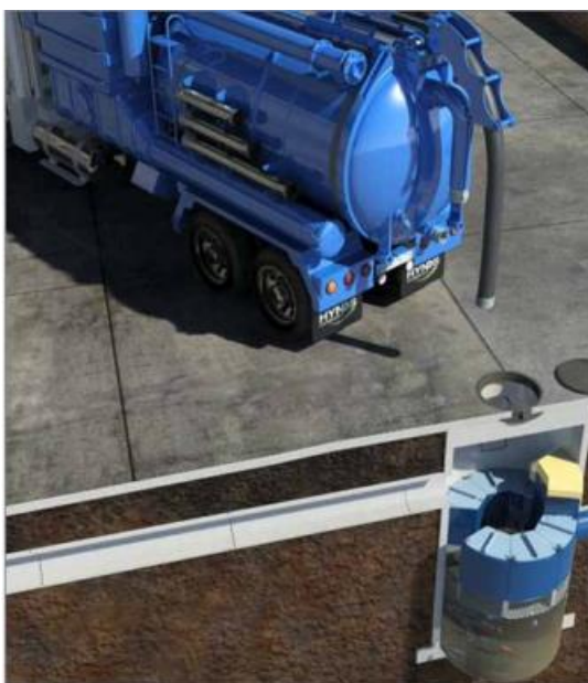
Fig.6.39 – Manutenção do sistema Up-Flo Filter [27]
