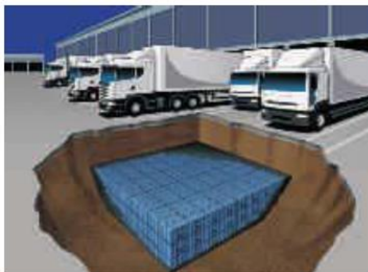
Fig.6.8 – Instalação de Aquacell Core em áreas industriais/comerciais [24]
